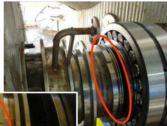
LabTecta-PB RDS zainstalowana na wale
