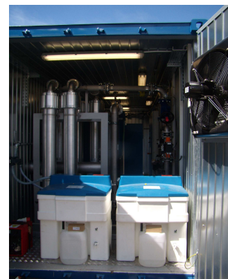
Wnętrze membranowego generatora azotu MGA-600-97
